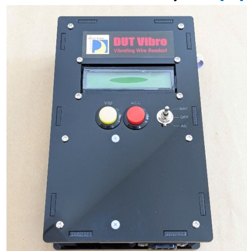
Fig. 7. Vibrating wire sensor readout DUT Vibro
