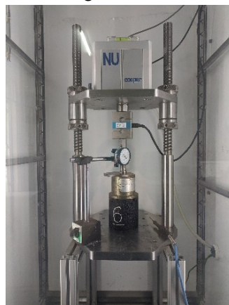
Hình 7. Quá trình thí nghiệm xác định E tĩnh
